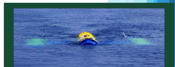
（株）IHIが開発し、平成29年8月に鹿児島県十島村で実証実験した水中浮遊式海流発電システム
