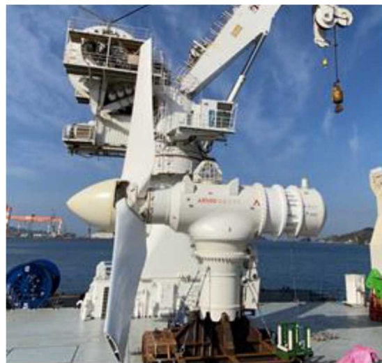
2021年2月に長崎県五島列島に設置された ブレード直径18mのAR500潮流タービン
