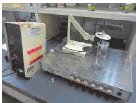
図2 フッ化物イオン選択性電極装置
