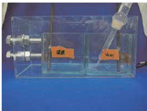
図1 電気化学的水素透過試験装置
