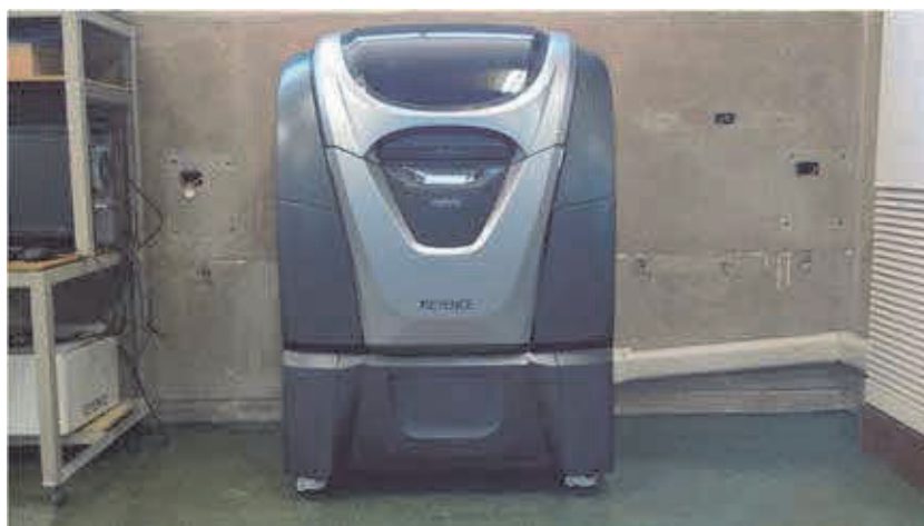
図3.10 地域コトづくりセンター 開発部門 機能創成室に導入された高精細3Dプリンター キーエンス社 AGILISTA-3100
